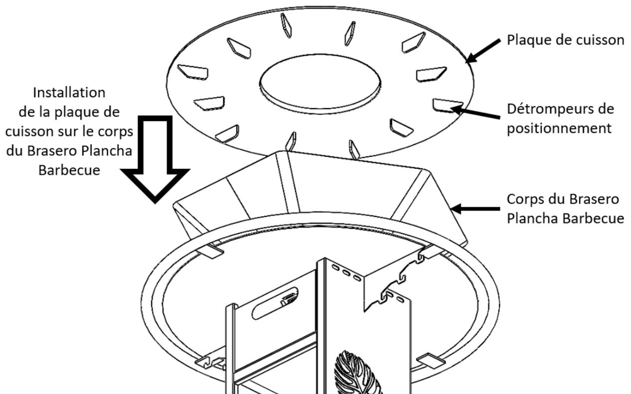
Pour vérifier son bon positionnement, la plaque de cuisson ne doit pas bouger, les guides doivent être "cachés" à l'intérieur de l'embase hexagonale.
